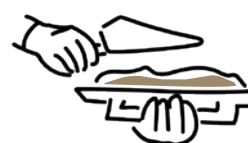
Mise en oeuvre à la truelle
